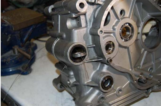
Die seitlich abgeflachte Ausdruckscheibe wird von der gegenüberliegenden Seite durch das Gleitlager geführt. Ein vorher durchgesteckter Draht verhindert, dass die Scheibe in den Motor fällt.
