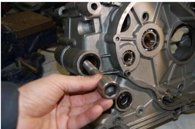
Die Zugschraube wird anschließend eingeführt. Erst wenn die Schraube die Ausdruckscheibe fixiert, kann der Draht herausgezogen werden
