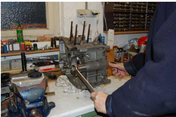
Durch Anziehen der Mutter wird das Gleitlager aus dem Gehäuse in die Buchse gedrückt. Die originalen Gleitlager sitzen sehr fest. Zur Unterstützung kann das Gehäuse durch ein Heißluftgebläse oder einen Propanbrenner erwärmt und damit ausgedehnt werden.
