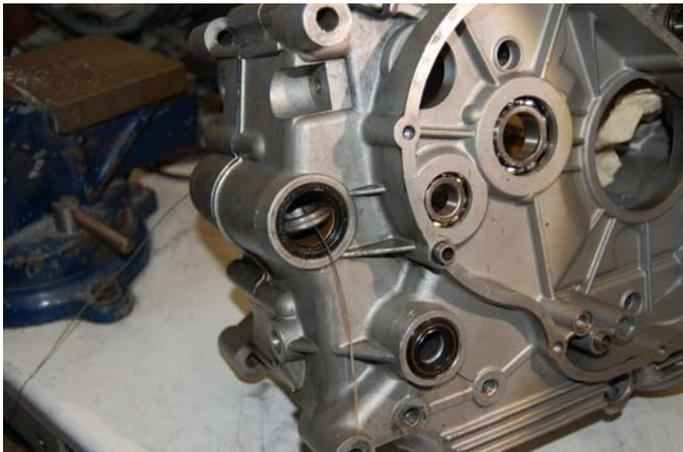
Die Scheibe wird weiter durchgesteckt und hängt dann im Motor auf dem Draht.
