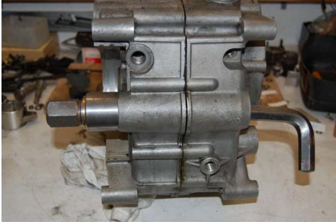
Das vollständig montierte Spezialwerkzeug. Ein Innensechskantschlüssel wird zum Gegenhalten durch den Motor gesteckt um die Zugschraube zu fixieren.
