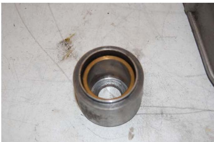
Das demontierte Gleitlager in der Ausrückbuchse.
