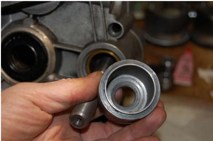
Die Ausrückbuchse wird jetzt aufgesetzt. Die Gleitlagerbuchse aus dem Motor wird später beim ausziehen hier hinein gezogen
