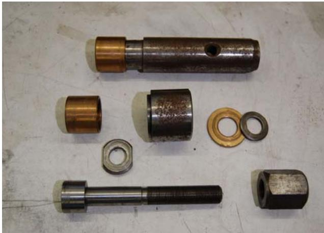
Eigenbau Spezialwerkzeuge für die Demontage der Schwingenlager (Gleitlagerbuchsen) an den Ducati-Pantah Motoren 500-750cm<sup>3</sup>
