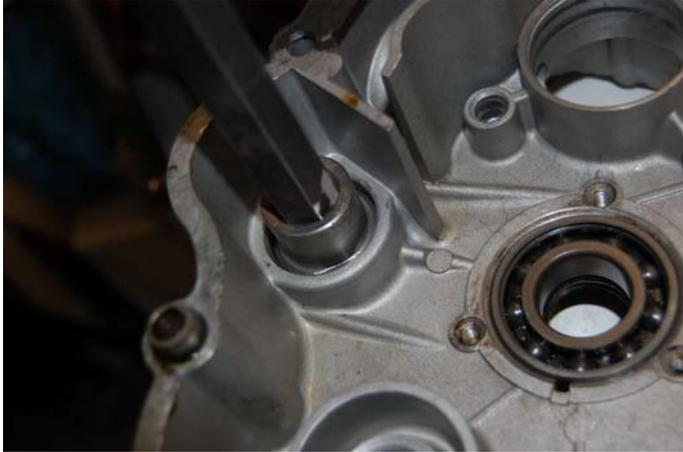
Die Gleitlagerbuchse ist bereits einige Millimeter herausgedrückt
