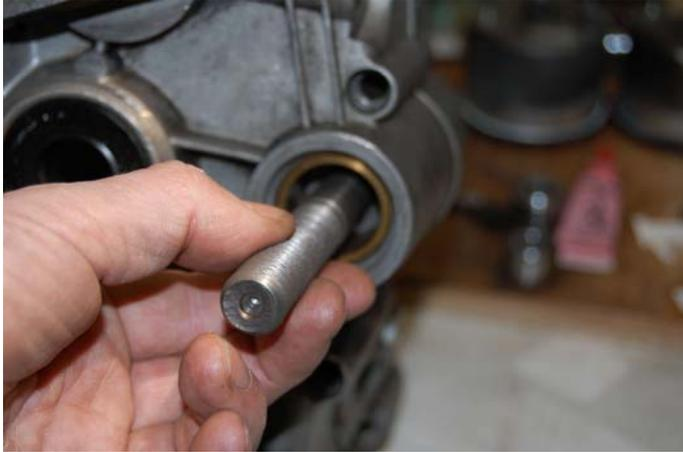
Jetzt zentriert die Zugschraube die Ausdruckscheibe
