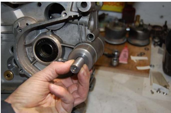
Die Ausdrückbuchse von außen auf die Zugschraube aufgesetzt.
