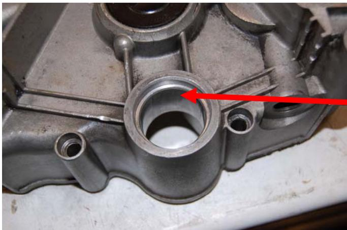
Gehäuse, ohne Gleitlagerbuchse.
