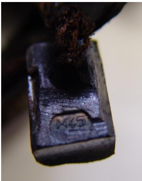
Die vier Anlasserkohlen haben die Bezeichnung M45 und sind im Querschnitt 10 x 6 mm. Die Länge beträgt im Neuzustand ca. 20mm. Bei einer früheren Reparatur habe ich diese Kohlen an die alten Kupferleitungen angelötet. Das ist einige Jahre und mehrere 10.000km her.
