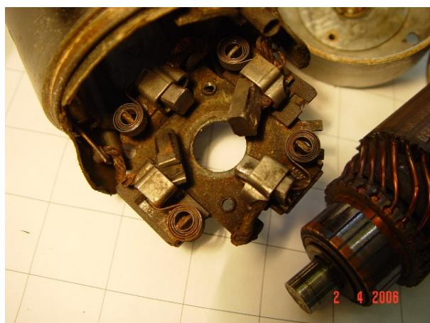
In meinem Fall ist der Schaden wohl am Kollektor zu suchen, er ist blau angelaufen und hat eine glasige Oberfläche. Da er keine Riefenbildung aufweist wird leichtes Schleifen mit feinem Schmirgelleinen abhelfen. Bei stärkerem Verschleiß muss der Kollektor auf einer Drehmaschine ein paar zehntel Millimeter abgedreht werden. Die Kohlen sind noch lang genug und durchaus weiterhin zu nutzen. Die Grundplatte sollte vom Kohlenabrieb gereinigt werden.
