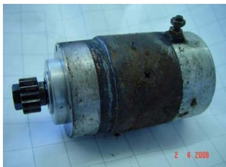
Nun lassen sich die drei M6 Schrauben lösen und der Anlasser kann herausgezogen werden. Da er sich immer im Spritzbereich des Vorderrades befindet, sieht er entsprechend mitgenommen aus.
